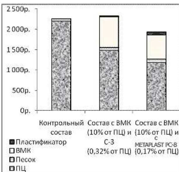
В таблице и на диаграмме представлена стоимость цемента, песка, метакаолина и пластификатора на кубометр бетона (то есть, стоимость кубометра бетона без учета стоимости щебня). Итак, стоимость бетона с добавлением метакаолина и FOX-8Н ниже контрольного состава на 325 руб./м.куб.
